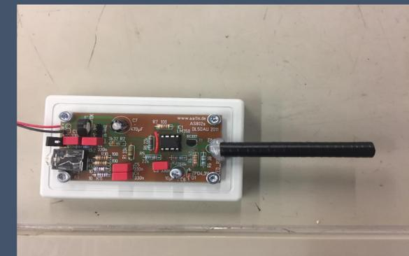
→ Der finale Entwurf überbrückt im Test > 20m
