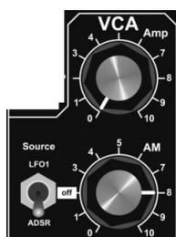
Die Amplitude – also die Lautstärke des Signals – wird über den **VCA-Regler** (spannungsgesteuerter Verstärker) eingestellt. Der darunterliegende **AM-Regler** (Amplituden-Modulation) variiert die Lautstärke entsprechend der am **LFO1** eingestellten Frequenz oder mit der Hüllkurve **ADSR**.
